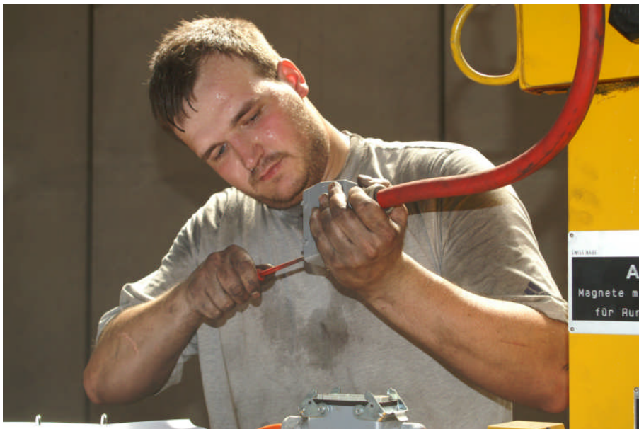
Figure 2: Prüfung und Wartung einer Steckverbindung
