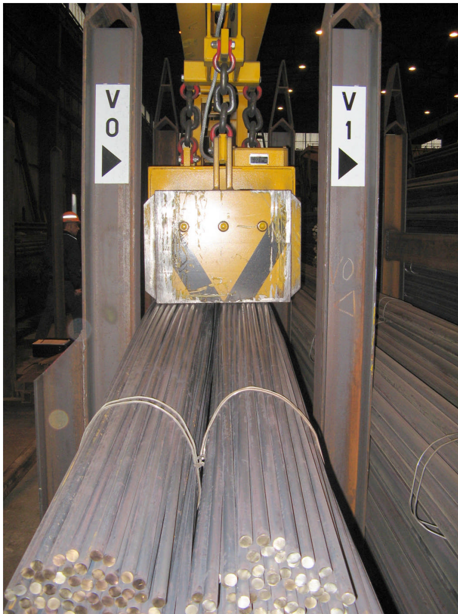
Figure 1: Lagerung der noch heißen Stabstahlbunde im Rungenlager
