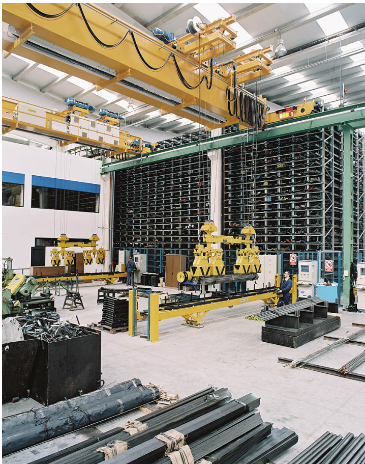
Figure 1: Einlagern der Stabstahlbunde ins Warenlager
