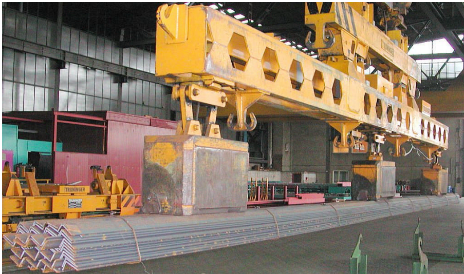
Figure 2: Festtraverse mit drei Magneten, als Wabenträger ausgeführt und mit einem Schnellwechselsystem versehen
