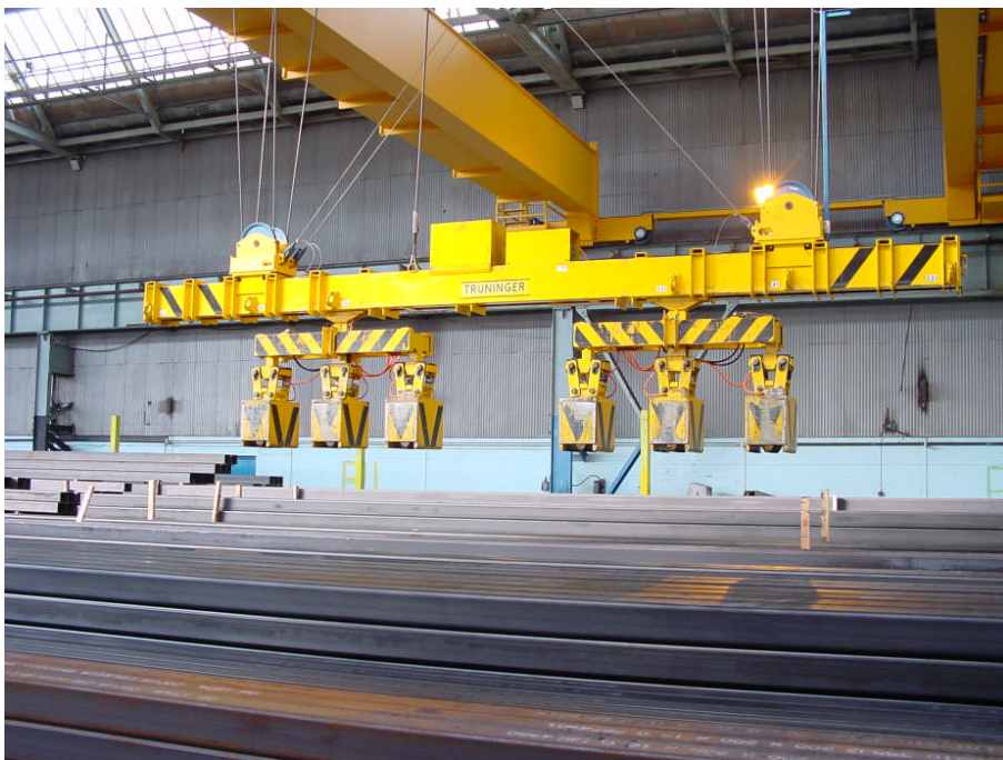
Figure 3: Festtraverse mit verschiebbaren Magnetgruppen
