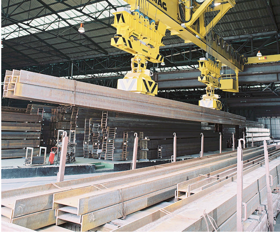
Figure 3: Zwei Einzeltraversen mit Schnellwechsel beim Entladen eines Eisenbahnwagons
