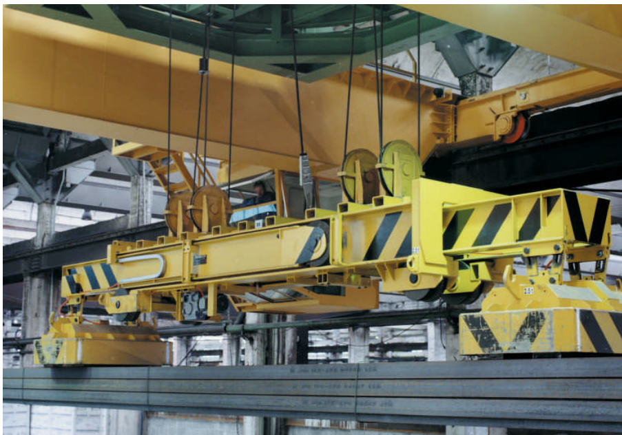
Figure 2: Magnetischer Transport eines H-Trägerbundes
