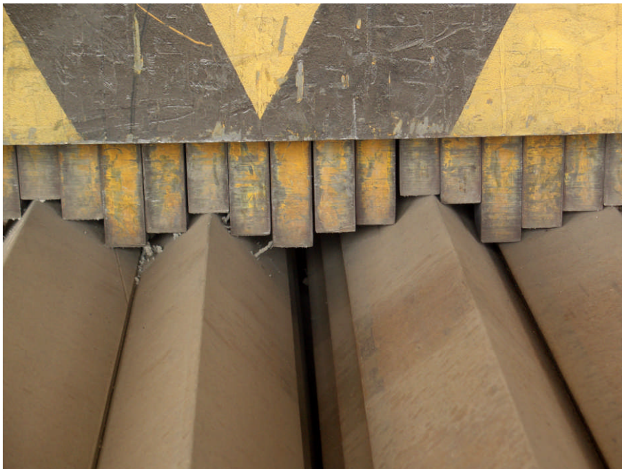
Figure 4: Fingerpole passen sich der Materialgeometrie des Winkelprofilbundes an
