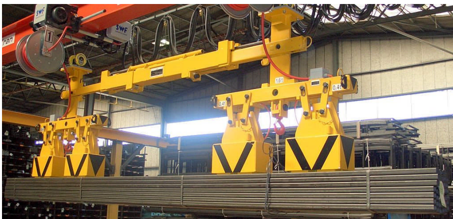
Figure 3: Passives Teleskop mit zwei Magnetgruppen beim Anheben eines Hohlprofilbundes
