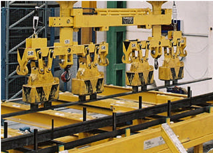
Figure 1: Pendelfreies Kommissionieren aus einer Kassette
