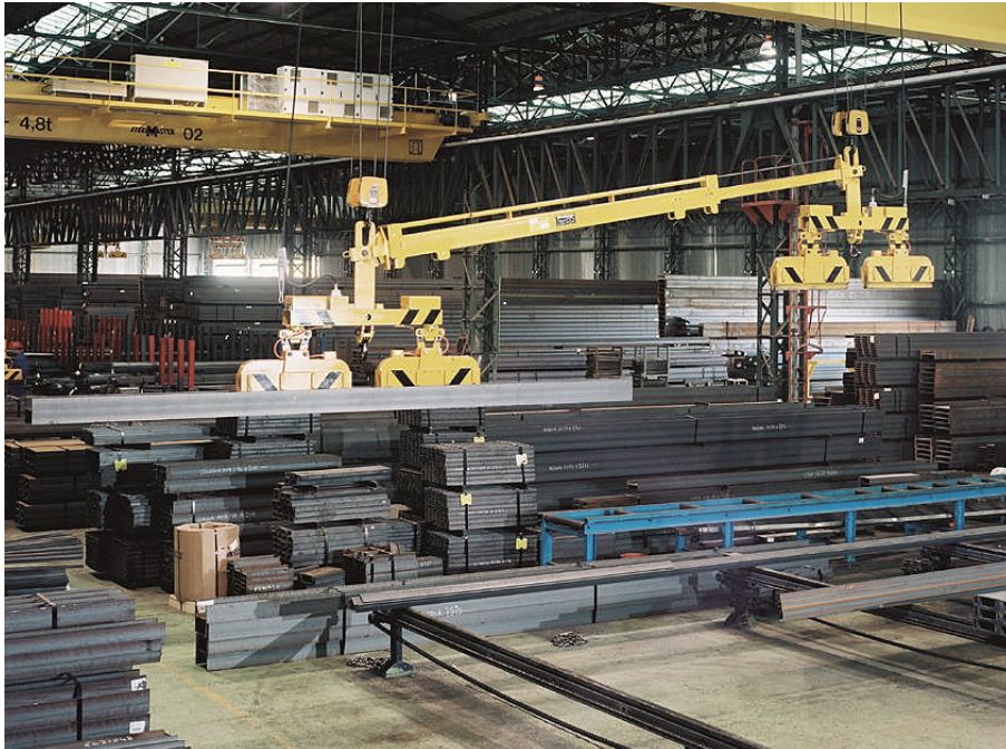
Figure 2: Entnahme eines kurzen Trägers mit einer Magnetgruppe
