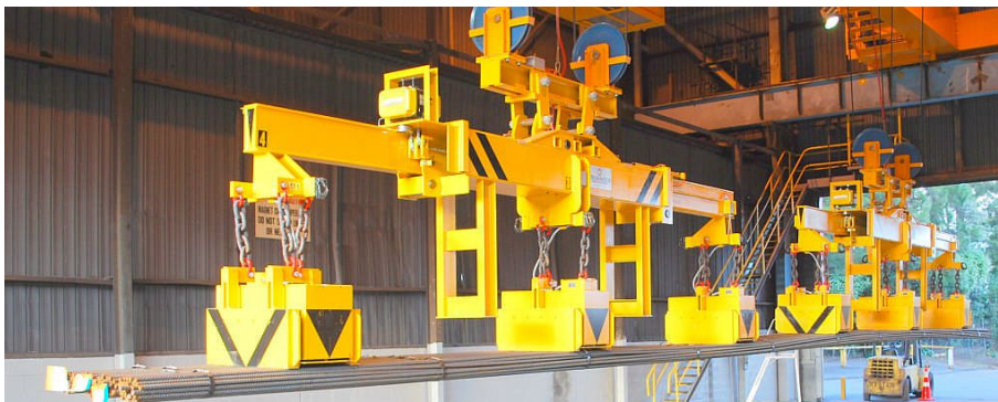
Figure 2: Zwei aktive Teleskope transportieren lange Betonstabstahlbunde
