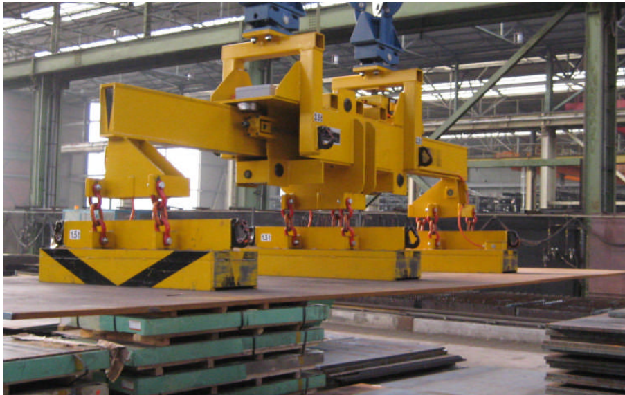
Figure 1: Aktives Teleskop beim Blechtransport
