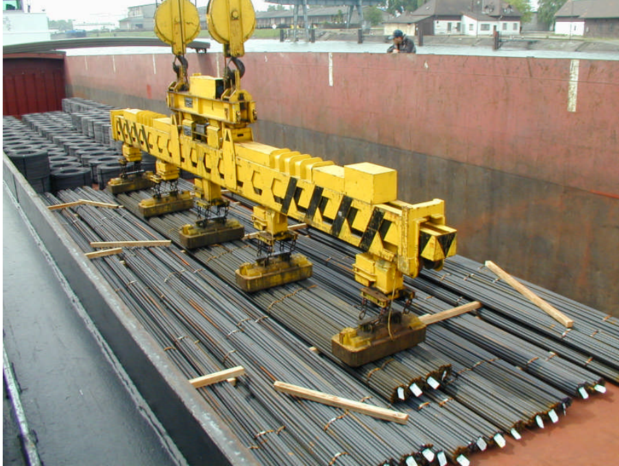
Figure 3: Aktives Teleskop beim Entladen von Betonstabstahlbunden aus einem Schiff
