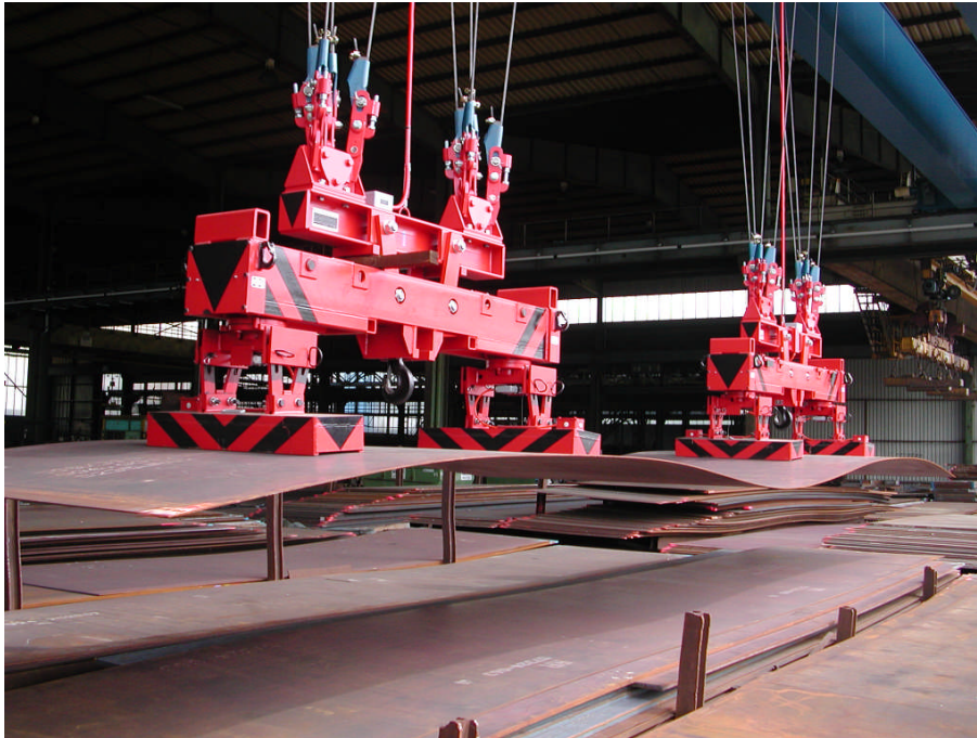
Figure 3: Zwei Einzeltraversen heben ein dünnes, langes Blech
