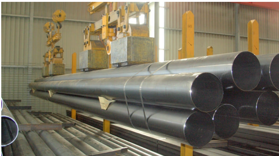
Figure 2: Entnahme eines Rohrbundes aus dem Rungenlager mit zwei Einzeltraversen
