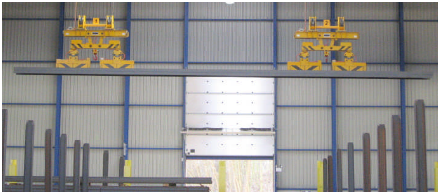
Figure 1: Zwei Einzeltraversen transportieren lange Trägerprofile
