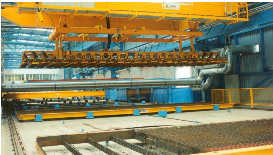
Figure 1: “Magneteteppich” mit 175 Ringmagneten zum Belegen und Abräumen einer Brennscheidmaschine mit Blechen von max. 12 x 3,5m
