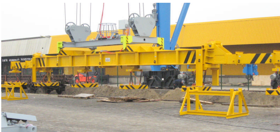
Figure 2: Festtraverse zum Grobblechtransport mit verfahrbaren Magneten und demontierbaren Erweiterungsarmen; Einsicherung der Traverse mittels Containertraverse
