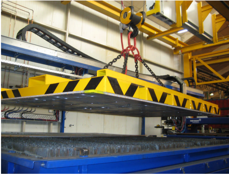
Figure 3: “Magneteteppich” zum Belegen und Abräumen von gross-formatigen Blechen in einem Arbeitshub
