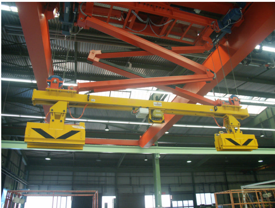
Figure 4: Sondertraverse zum Transport von LKW-Rahmenträgersets
