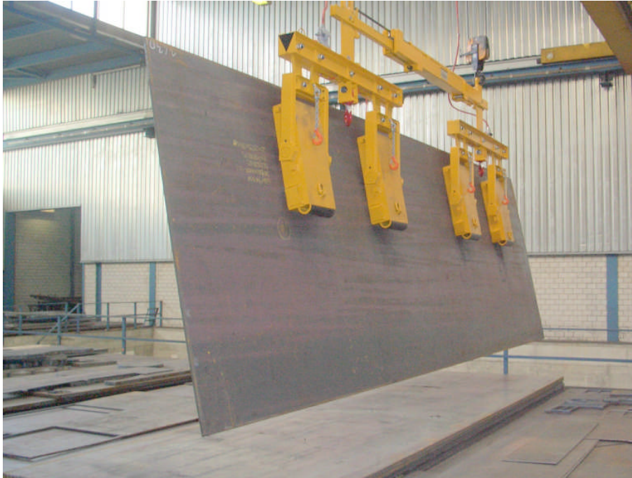
Figure 2: Aufnahme einer horizontal liegenden Last
