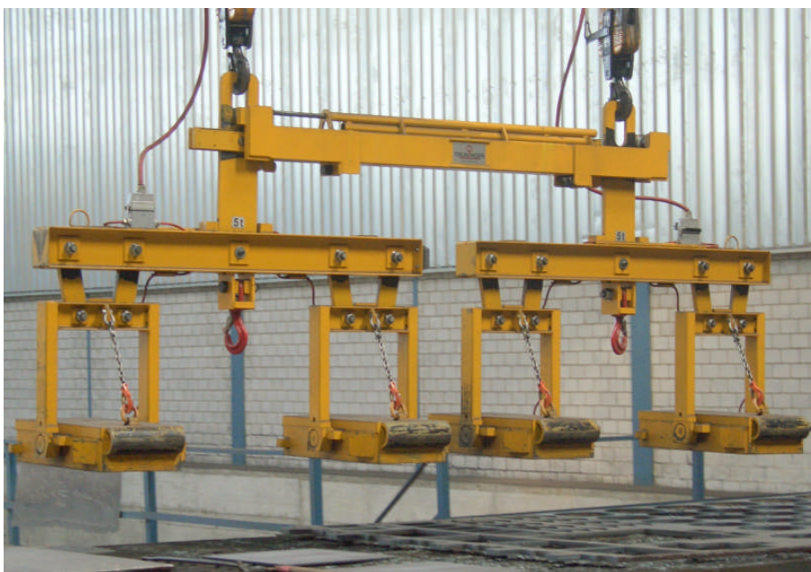
Figure 3: Magnete in horizontaler Stellung arretiert
