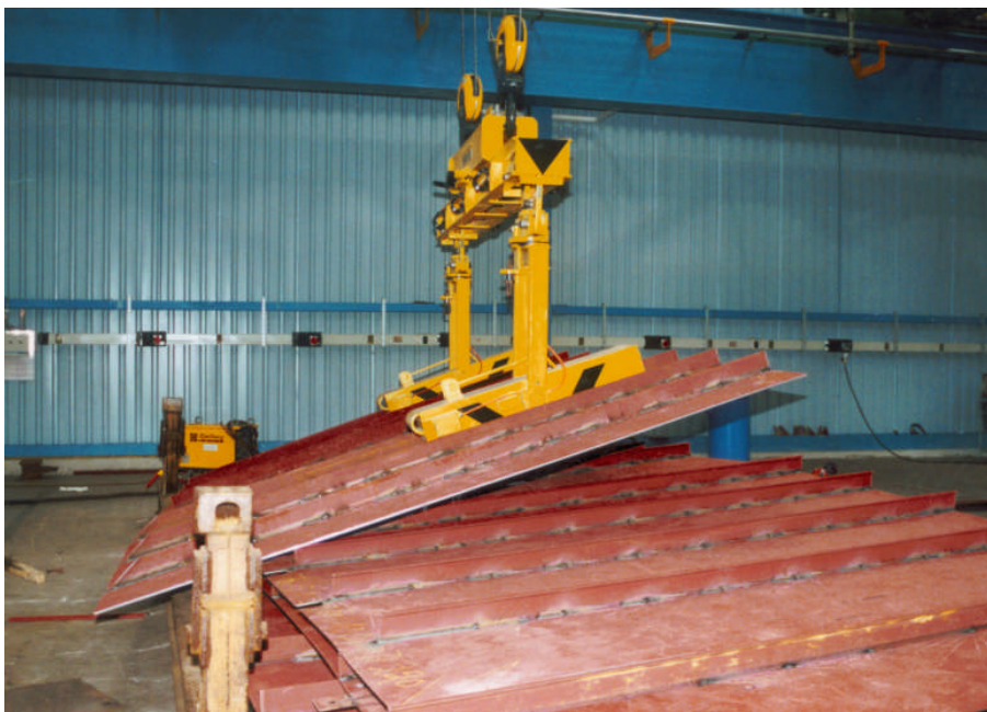
Figure 5: Transport von Schiffswänden auf einer Wert
