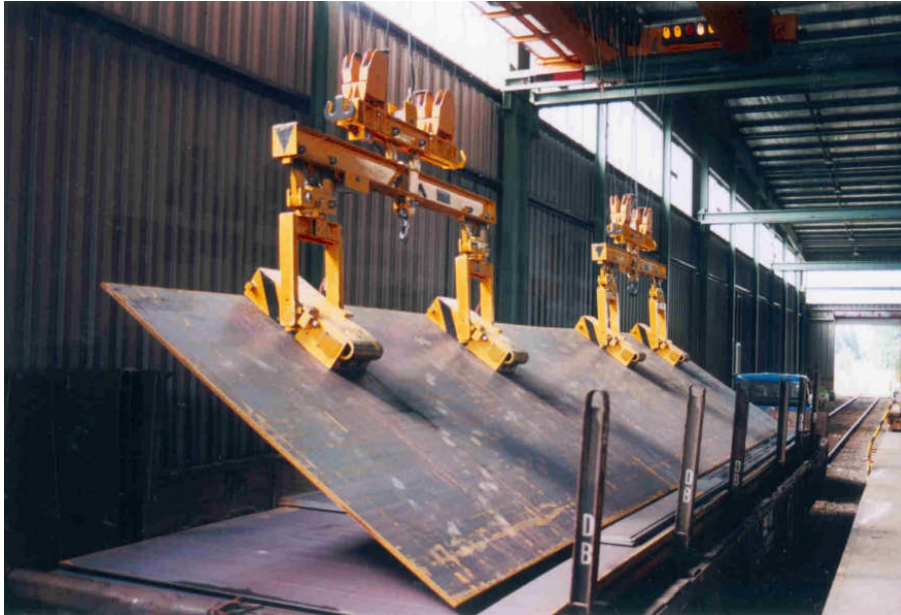
Figure 4: Waggontladung. Aufnahme von breitem Grobblech
