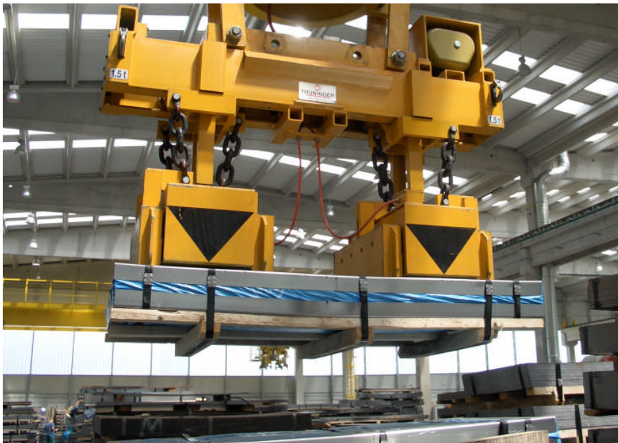
Figure 2: Formatblechtransport mit tief eindringendem Magnetenfeld
