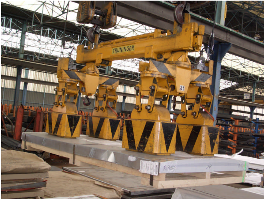
Figure 3: Formatblechtransport mit passivem Teleskop
