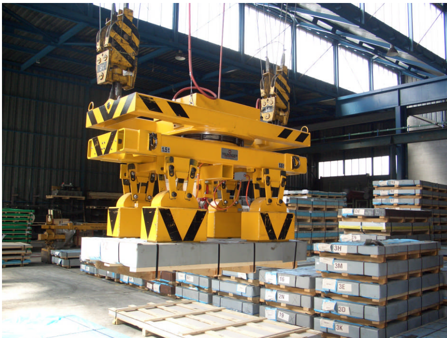
Figure 1: Formatblechpaket an Traverse mit verschiebbaren Magnetgruppen und mit Lastdrehwerk
