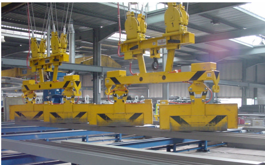
Figure 3: Zwei Einzeltraversen mit Schrägseilverspannung für pendelfreies Greifen von schmalen Trägern
