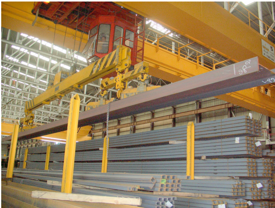
Figure 1: Hohe Lagerdichte mit TRUNINGER-Magnetanlage
