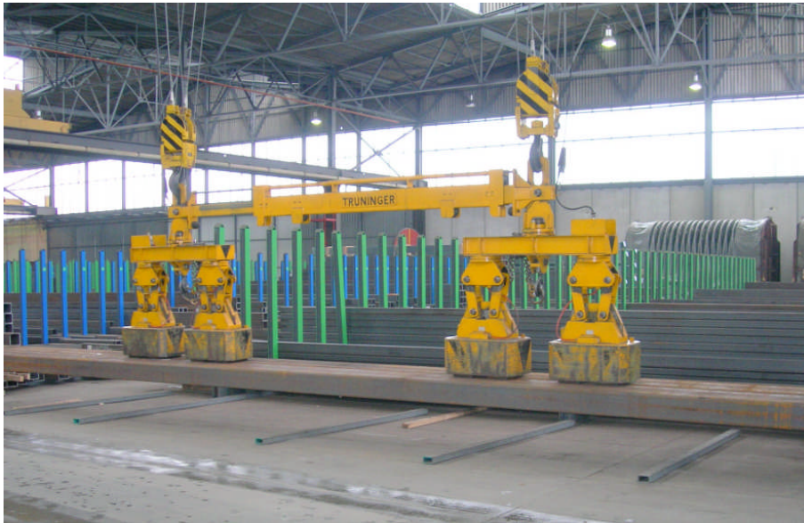
Figure 2: Passives Teleskop beim Transport einer Hohlprofil-Lage
