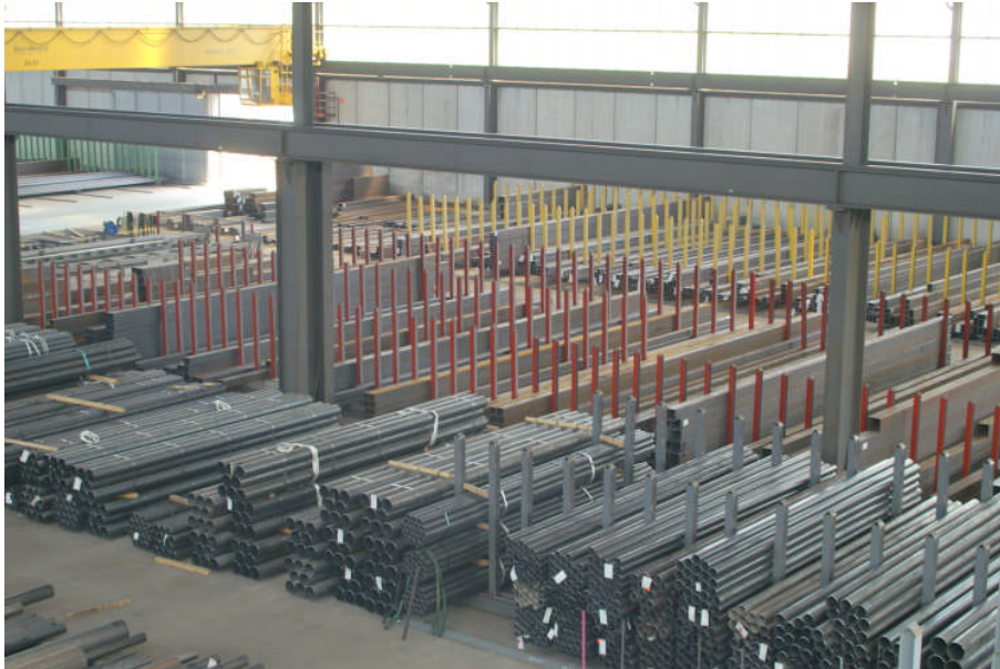
Figure 4: Kostengünstige Kompaktlagerung von Langgut mit Hilfe einer Magnetanlage
