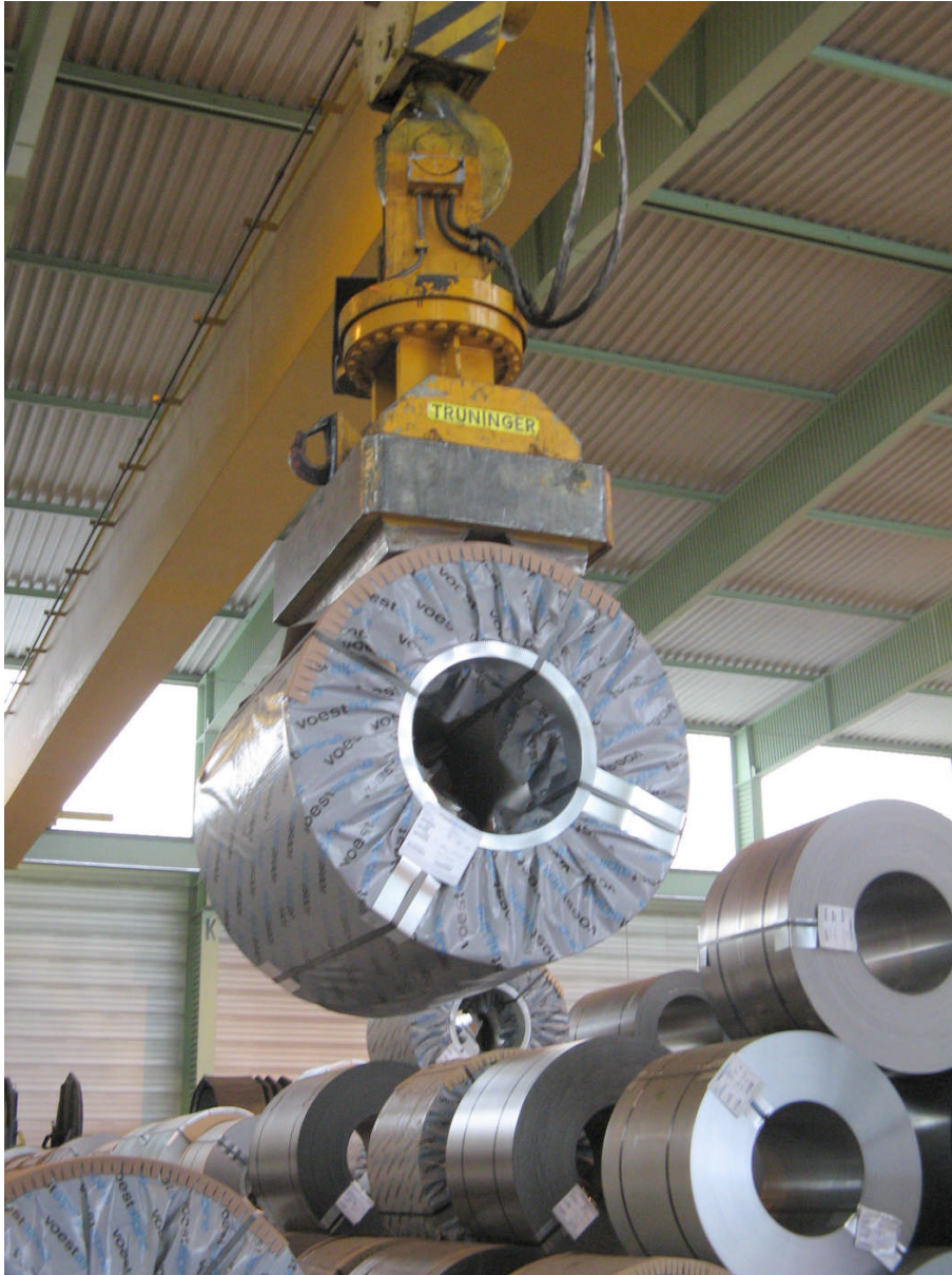
Figure 3: Ein Lastdrehwerk in Kombination mit einem Coilmagneten
