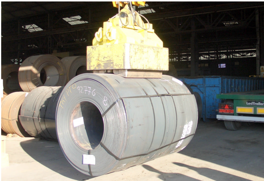
Figure 2: Einlagerung eines Warmbandcoils in eine Lagerhalle Beachte Luftspalt
