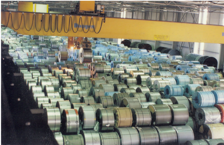
Figure 2: Hohe Lagerdichte in einem Coillager bei magnetischer Lagerung
