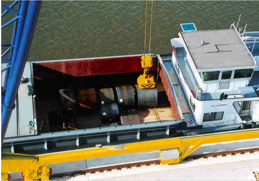
Figure 3: Total redundant ausgelegte Magnetanlage, wichtig bei einer Schiffbeladung
