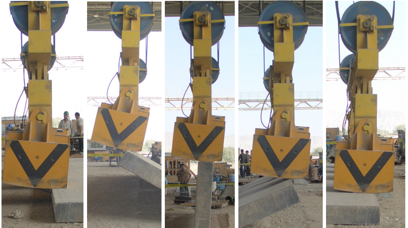
Figure 2: Magnetisches Wenden einer Bramme
