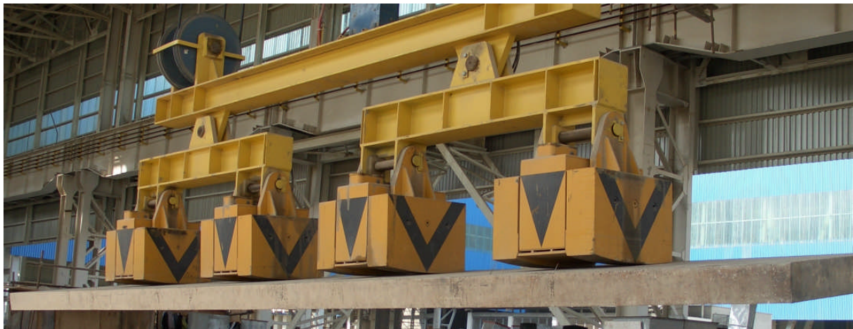
Figure 1: Brammenwende-Magnete beim Entstapeln einer Bramme zur weiteren Anarbeitung
