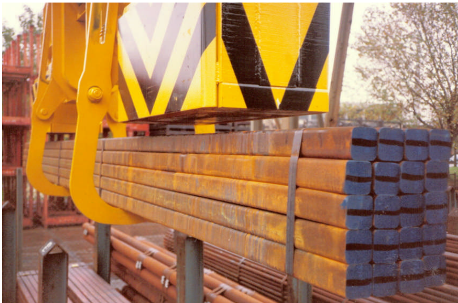
Figure 1: Sicherheitsgreifer mit gesicherter Last
