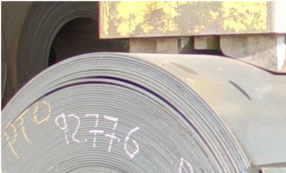
Figure 1: Luftspalte in der Wicklung der Warmbandcoils
