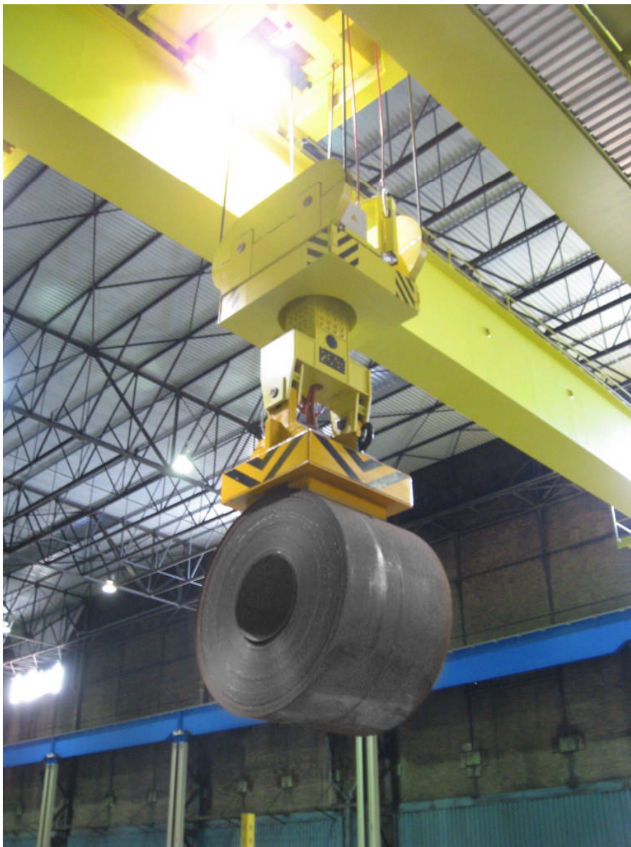
Figure 3: Einlagerung eines Warmbandcoils in das Coillager
