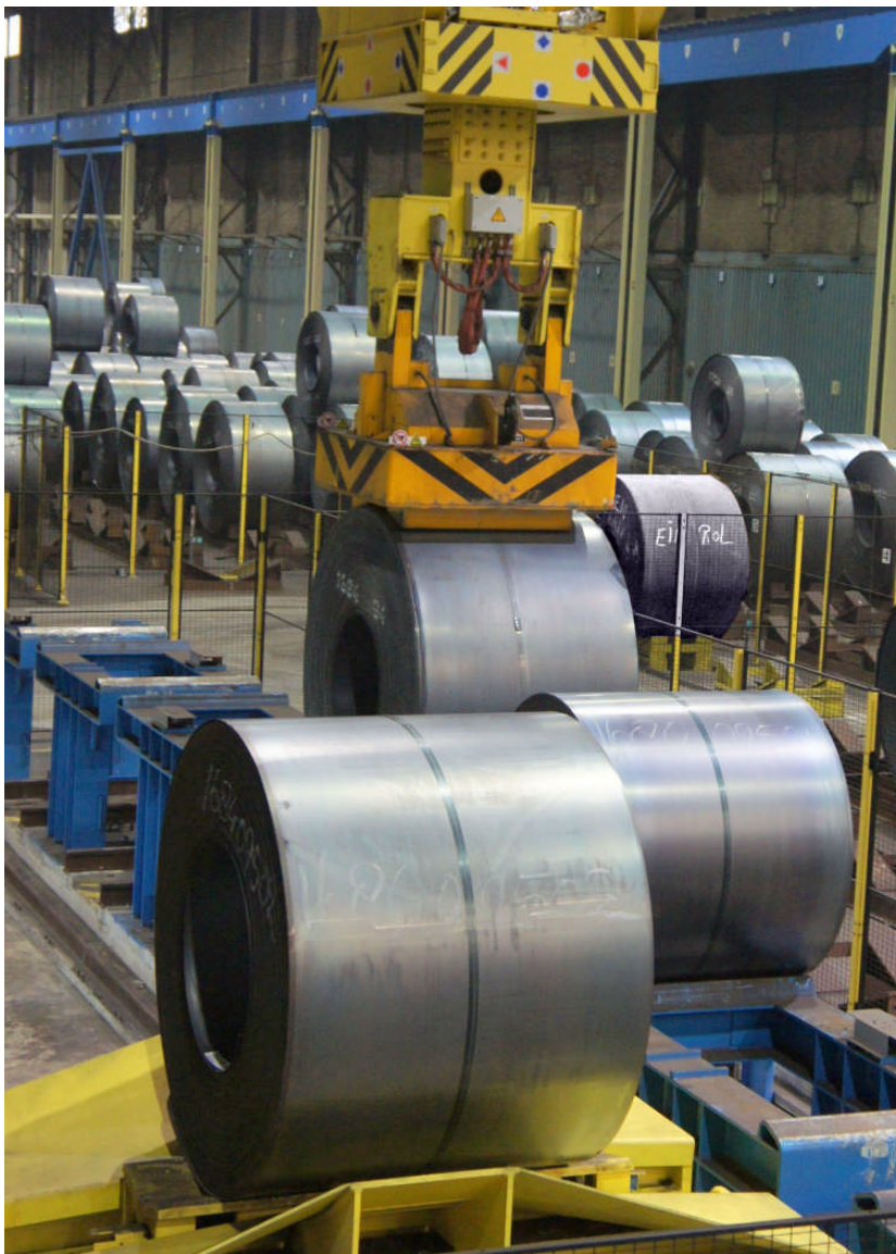
Figure 4: Coil zum Absetzen auf die Transportvorrichtung bereitgestellt
