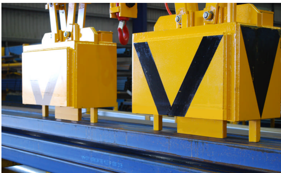
Figure 3: Präzises Kommissionieren von Einzelrohren dank dem genial-einfachen Schiebanker-System von TRUNINGER
