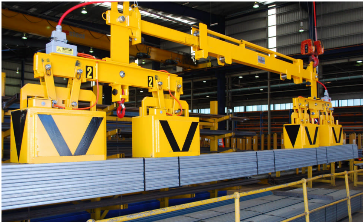
Figure 1: Sicherer und schneller Umschlag von Rohrbunden mit der neuen Magnetreihe TM
