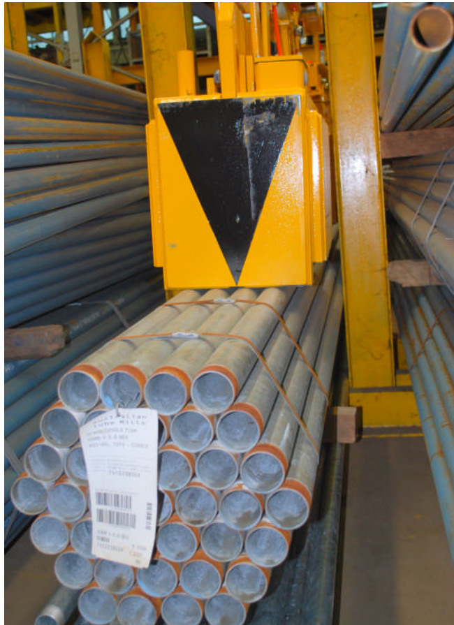
Figure 2: Müheloses Handling der Rohrbunde in engen Rungenlagern dank minimaler seitlicher Anziehung
