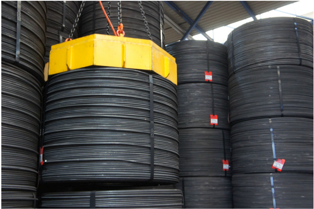
Figure 3: Hohe Lagerdichte beim magnetischen Stapeln der Betonstahlringe
