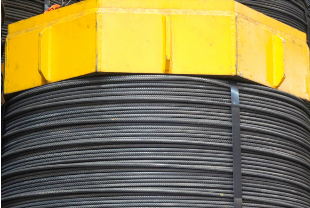
Figure 2: Neuer Betonstahling-Magnet auf 5t Last
