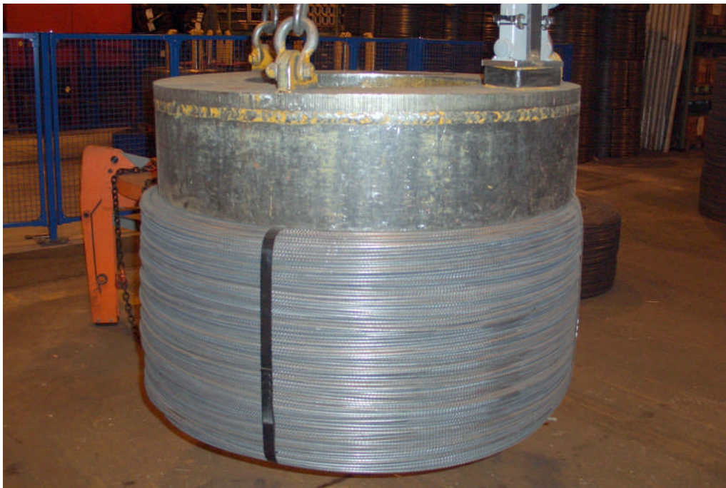
Figure 1: Magnetisches Heben eines 3t schweren Betonstahlringes mit Durchmesser 1'200mm
