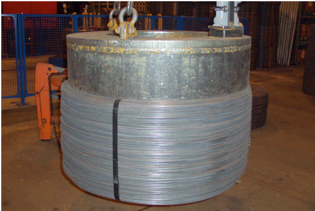
Figure 1: 3 トン、外径 1200mm の線材コイルのマグネット搬送
