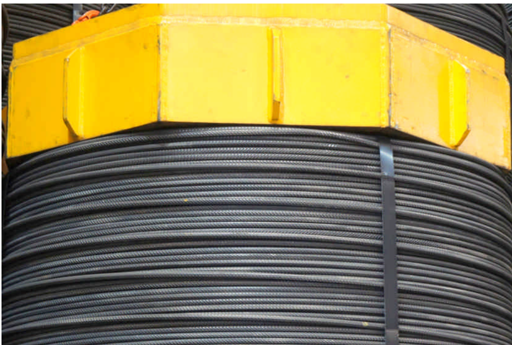
Figure 2: 新しい線材コイル搬送マグネット 5 トン吊り
