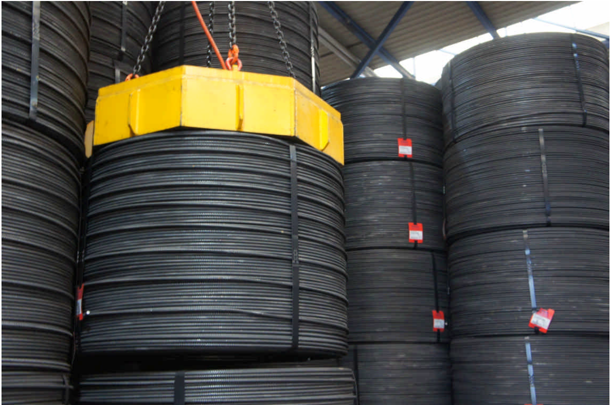
Figure 3: マグネットによる鉄筋線材コイルの高密度保管
