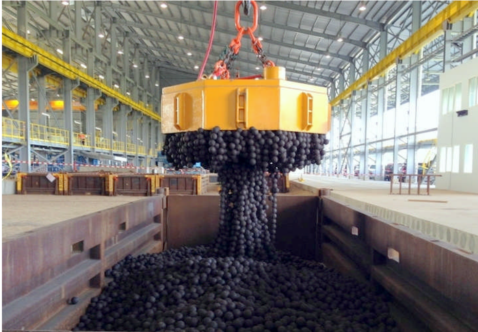
Figure 3: Tiefgreifendes Magnetfeld auch bei kleiner Schüttdichte
