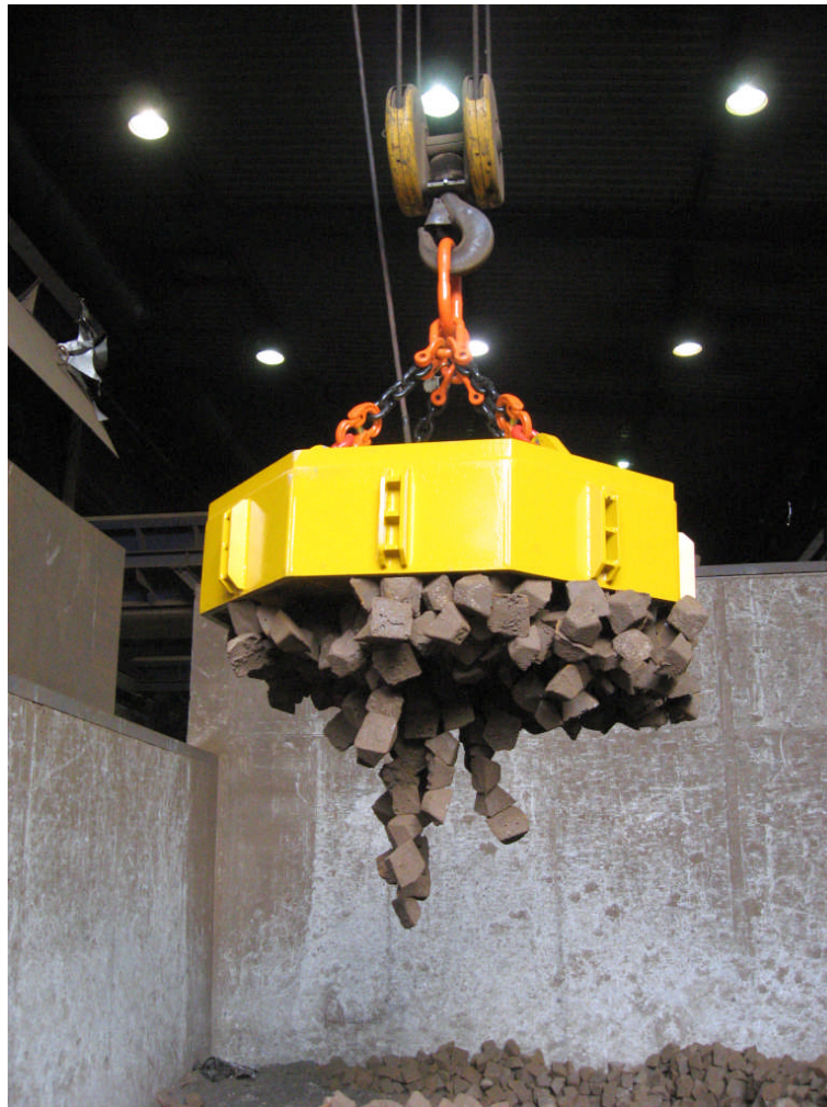
Figure 1: Aufnehmen von Masseln und abwiegen der vorgegebenen Menge
